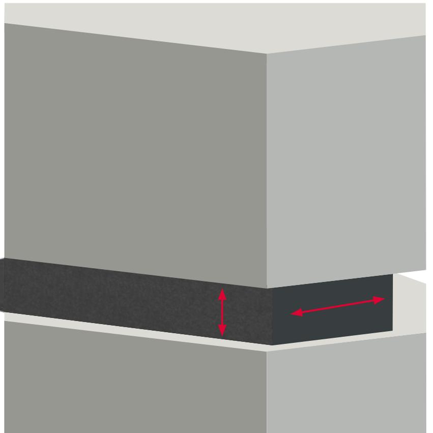
Bei der vorhandenen Fugentiefe orientiert man sich bei der Produktauswahl an der Produktbreite.
