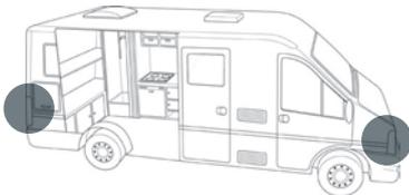
Kunststoffeinbauteile und Verblendungen, wie beispielsweise Blinker, Beleuchtung, usw., die integriert oder aufgeschraubt sind, werden mit Butyl Flachprofilen oder pastösem Dichtstoff montiert.
