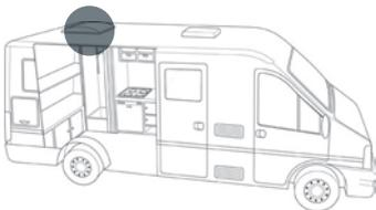
Die Dachabdichtung zählt zu den wichtigsten Abdichtungen überhaupt. Verwenden Sie hierfür einen leistungsstarken Dichtstoff auf Butylbasis als Rundprofil. Die Rundprofile lassen sich leicht in die Dichtkanäle legen und gleichen beim Verpressen mögliche Toleranzen aus.
