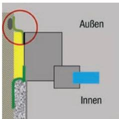
**EGO UNIVERSALVLIES** besteht aus einem überputzbaren, dampfdiffusionsoffenen PES-PE-PES Laminat. **EGO UNIVERSALVLIES** wird mit der einseitigen Selbstklebekaschierung am Fensterahmen fixiert und am Mauerwerk mit **EGOPLAST FK** verklebt.
