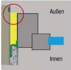
**EGOPLAST FK** ist besonders geeignet für die luftdichte Verklebung und Fixierung von Fensteranschlussfolien an der Außenseite. **EGOPLAST FK** wird an die Außenseite des Mauerwerkes zur Verklebung der Dichtfolie raupenförmig aufgebracht.
