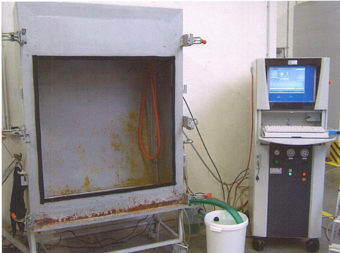
Bild 1: Versuchsstand mit Regeleinrichtung ohne Prüfkörper
