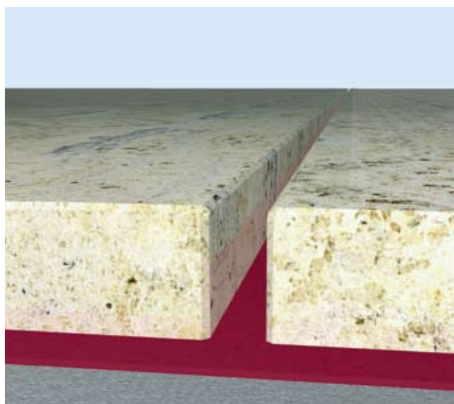
Natursteinverklebung auf Betonboden
